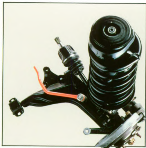
McPherson onafhankelijke voorwielophanging met schroefveren en stabilisator.
