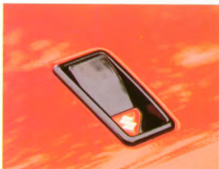
Motorkapontgrendeling handig in merkschildje verwerkt.
