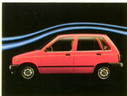
Aerodynamisch ontwerp (Cw 0.36 !) zorgt voor lager verbruik.
