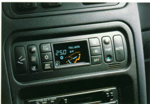
Volledig automatisch airconditioningssysteem.
