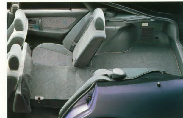
Bij de Galant hatchback kunnen de leuningen en de zittingen van de achterbank gescheiden naar voren worden geklapt. Zo kan de bagageruimte aanzienlijk worden vergroot.
