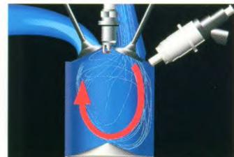
De speciaal gevormde zuiger zorgt dat het mengsel van brandstof en lucht naar de bougie wordt gestuwd en er optimale verbranding plaatsvindt.
