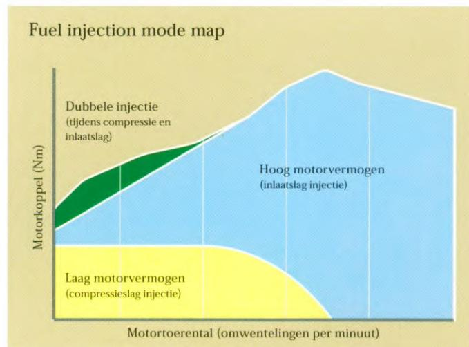
De GDI-techniek past het moment van brandstofinspuiting aan het rijgedrag aan. In de Ultra Lean Combustion Mode verbruikt de GDI-motor, bij rustig rijgedrag in de stad of op de snelweg, evenveel brandstof als een diesel. Wanneer u meer vermogen nodig heeft, schakelt de motor automatisch over op de Superior Output Mode en presteert als de krachtigste benzinemotor. Daarnaast mag zeker niet onvermeld blijven dat de GDI-techniek de uitstoot van schadelijk CO<sub>2</sub> aanzienlijk vermindert.
