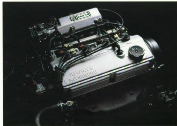
De 1.8 en 2.0 liter 16 kleppen Multipoint-injectie motor koppelt de kracht van vier kleppen per cilinder aan de prestaties van een SOHC-kraftbron. Over soepel en sterk gesproken.
