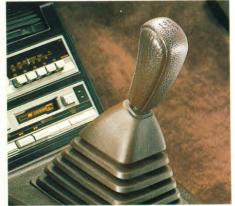
5-versnellingsbak waarvan de vijf een overdrive is
