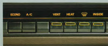
Op het dashboard bevinden zich de toetsen voor ventilatie en verwarming (GLS).
