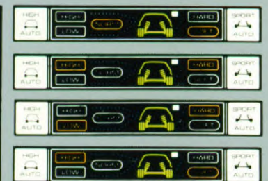
De instelmogelijkheden van de ECS op het dashboard van de Galant GLS/E.
