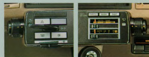
Linkerzijde van het funktiepaneel met alle verlichtingfuncties, de richtingaanwijzers en de regelbare instrumentenverlichting. Rechterzijde met voorkeuzemogelijkheid voor verwarming en ventilatie, en de ruitewissers met variabele interval (GLS).
