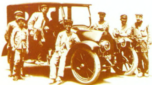
Dit model met zeven zitplaatsen en een motor van 35 DIN pk was de eerste, in serie geproduceerde auto in Japan.
