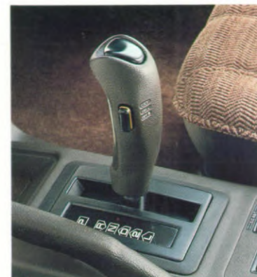
De elektronisch gestuurde automatische vierversnellingsbak met ergonomisch ontworpen drukknoppen en de tweestanden schakelaar voor snel of zuinig rijden.
