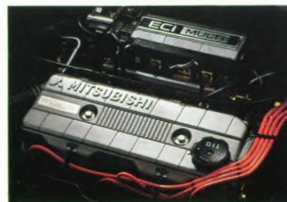
2.0 liter OHC ECI Multi-Point Injectie (benzine)
