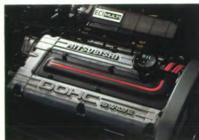
2.0 liter 16V DOHC ECI Multi-Point Injectie (benzine)
