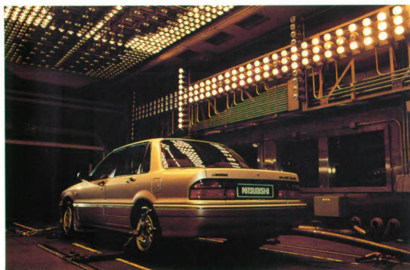
Tests onder extreme temperaturen bepalen de betrouwbaarheid van de materialen en de duurzaamheid van de lak.
