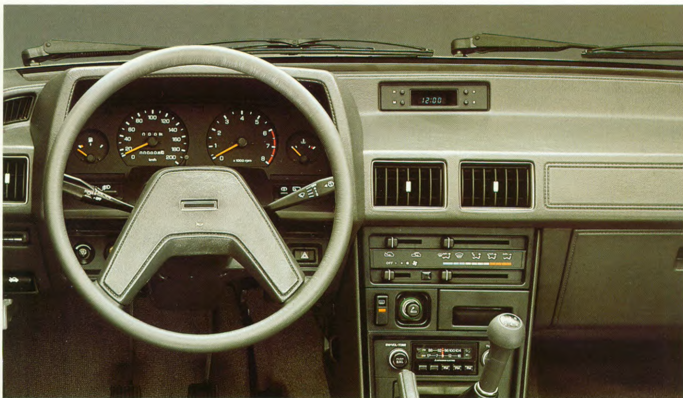
Het hierboven afgebeelde dashboard van de Galant Stationwagon 2000 GLX is opvallend luxe en compleet. Standaard zijn o.a. toerenteller, regelbare dashboardverlichting en het digitale quartzklokje. Hetzelfde geldt voor de AM/FM stereo radio.
