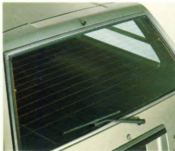
③ Achterruit met verwarming en wis-/was installatie
