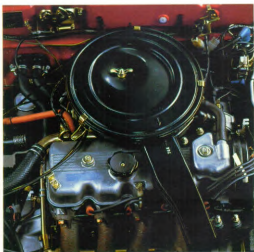
De 1600 cc benzinemotor met het unieke balansassensysteem.
