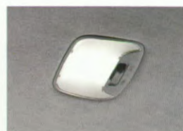
De interieurverlichting is zo plat mogelijk tegen het plafond gemonteerd.
