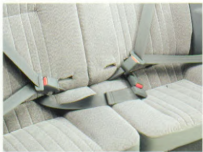
Driepuntsgordel links en rechts plus een heupgordel middenin bieden passagiers achterin optimale bescherming.
