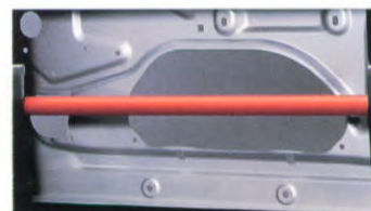
In de portieren bevinden zich stalen balken ter verhoging van de veiligheid in het geval van een zijdelingse aanrijding.
