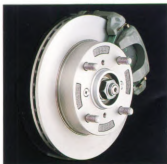
Een korte remweg dankzij geventileerde remschijven voor.
