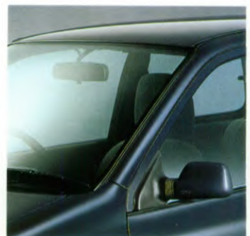
In de carrosserie verzonken voorruit en achterraamen voor minder geluid en strakere lijnen.
