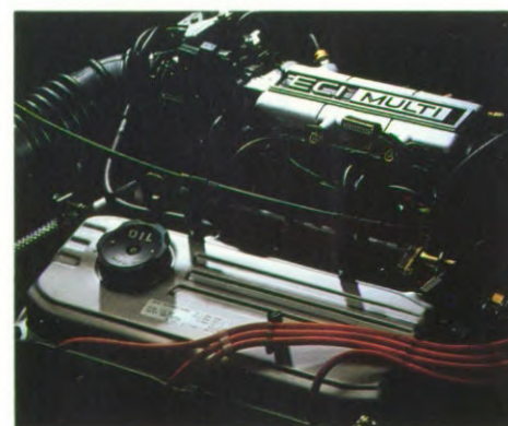
ECI-Multi motor (1.5 GLi (AUT) en 1.5 GLXi (AUT)) Maximum snelheid: 165 km/h (handgeschakeld) Maximum vermogen: 62 kW/5500 tpm Maximum koppel: 122 Nm/3000 tpm
