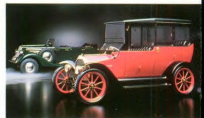
De allereerste Mitsubishi, Model A. Daarachter de Mitsubishi 4WD PX33 convertible met een 6-cilinder 4390 cc dieselmotor uit 1934.
