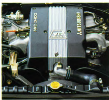
De 3.5 liter V6 DOHC benzinemotor met 24 kleppen. Door de toepassing van een stalen krukas worden trillingen geminimaliseerd en de weerstand verlaagd.
