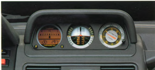
Meters voor binnen-/buitentemperatuur, hellingshoek en hoogte. (In Nederland wordt een ander model meter geleverd.)
