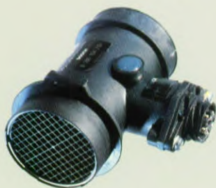
De luchtmassameter zorgt voor een optimaal brandstof-/luchtmengsel.
