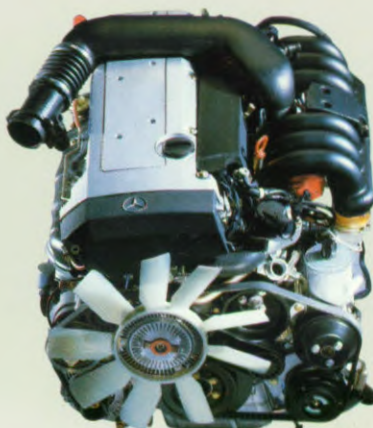
De benzinemotoren met vierkleppen-techniek: de viercilinder van de E 220 en de zescilinder motor van de E 320.
