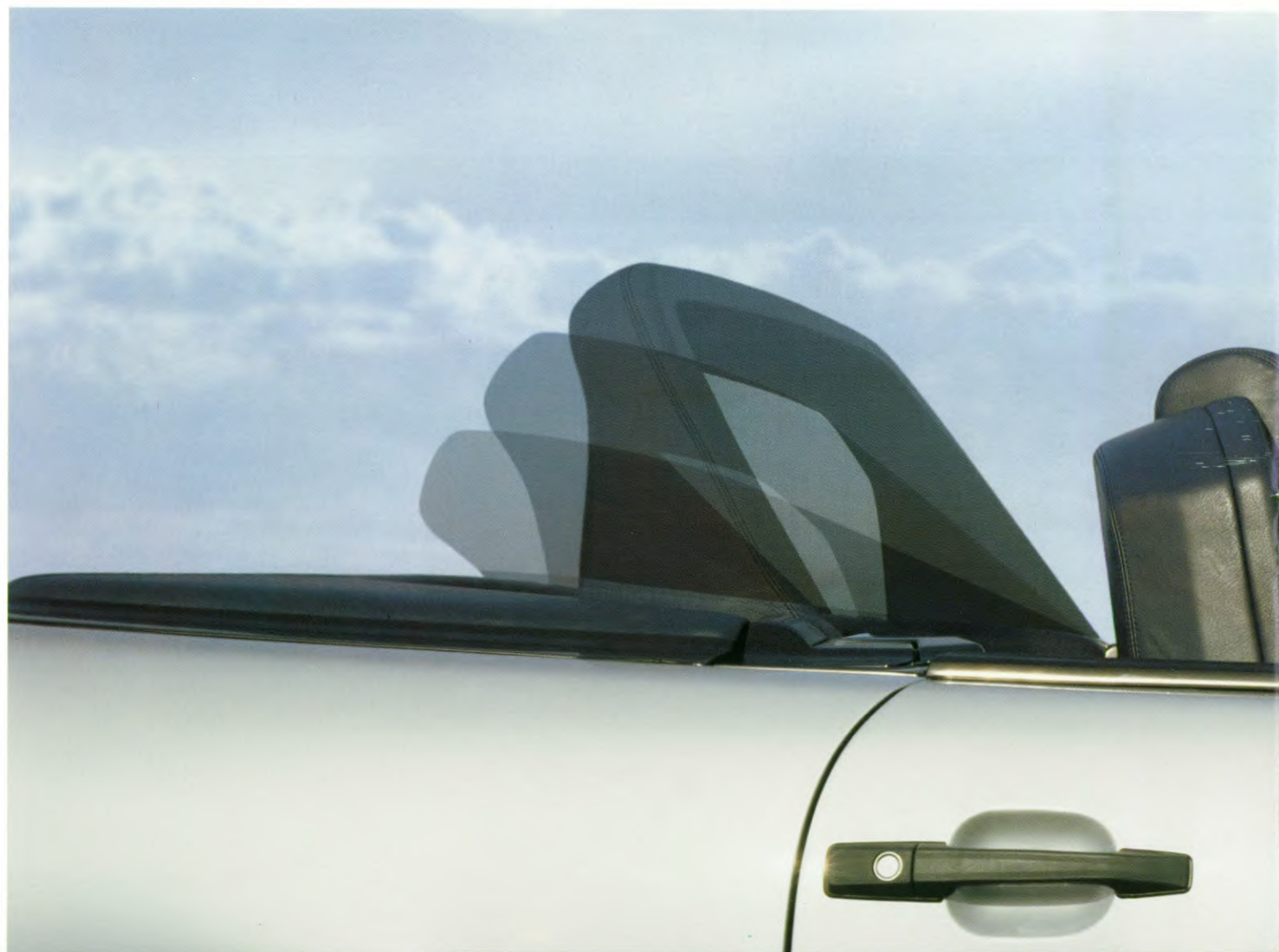
frakties van een seconde later: de in het startapparaat geïntegreerde kantelhoekschakelaar geeft de elektronika het signaal,
