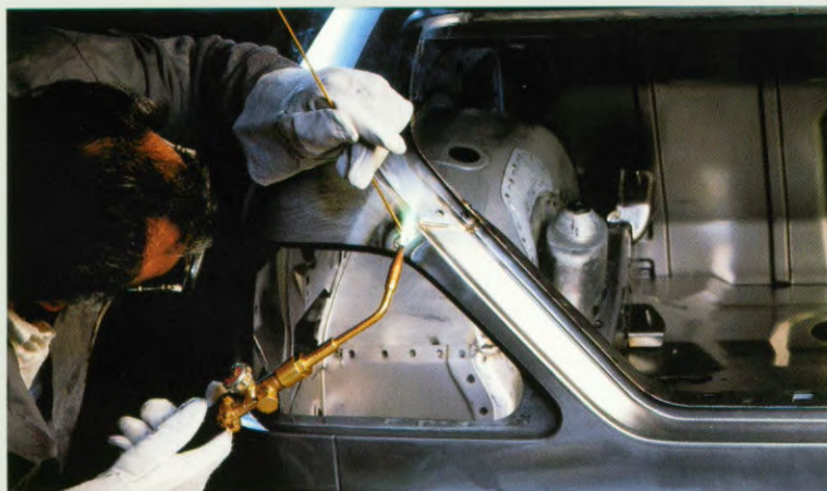
Ter wille van de kwaliteit wordt het achterpaneel van elke S-klasse Coupé handmatig gelast.
