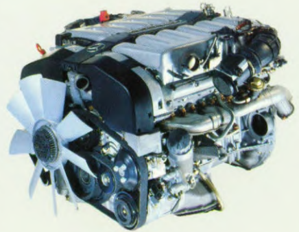
De krachtbron van de S 600: een twaalfcilinder motor met 48 kleppen.
