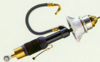
De niveauregeling zorgt voor een konstant wagenniveau.
