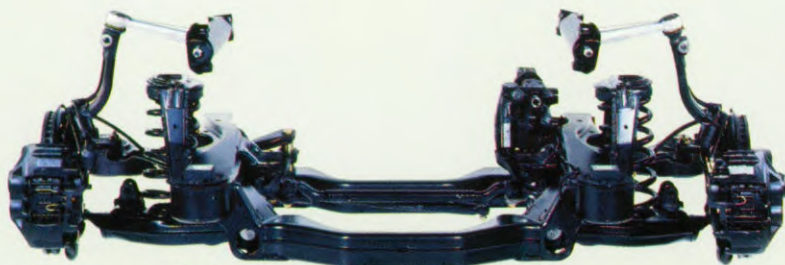
De vooras met dubbele wiellraagarmen zorgt voor een nog beter rijgedrag.
