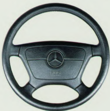
Onder normale omstandigheden merkt u niets van de aanwezigheid van de Airbag. Indien nodig, wordt deze in 30 millisekonden opgeblazen.
