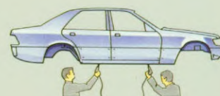
PVC-afdichting van de naden
