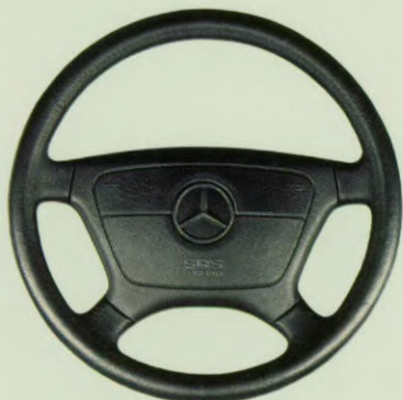
Onder normale omstandigheden merkt u niets van de aanwezigheid van de airbag. Indien nodig, wordt deze in dertig millisekonden opgeblazen.
