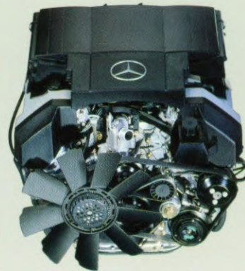
De achtcilinder motor van de E 420.
