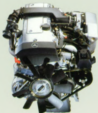
De viercilinder motor van de E 230.
