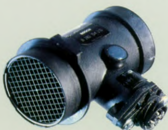
De luchtmassameter zorgt voor een optimaal brandstof-/luchtmengsel.
