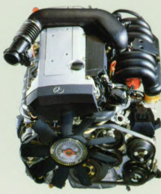
De zescilinder motor van de E 320.
