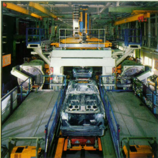
Een flexibele produktielijn voor de montage van de personenwagenkarrosserieën in onze fabriek te Sindelfingen bij Stuttgart.
