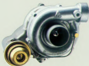
Het hart van elke turbomotor: de turbokompressor.
