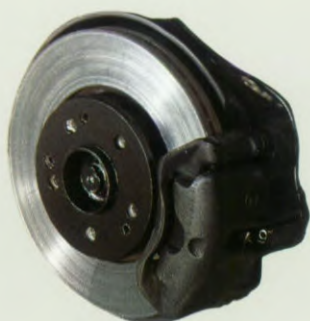
De remschijven. Een optimale geleiding van de koellucht zorgt voor een betrouwbare werking.
