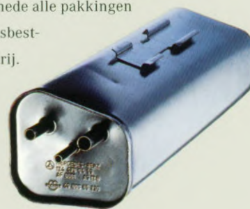
Het actief koolfilter zuigt de benzinedampen op en voert ze bij lopende motor naar het brandstofsysteem terug.
