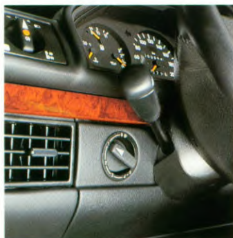
De koplamphoogteverstelling voorkomt verblinding van het tegemoetkomende verkeer wanneer de laadruimte is volgeladen
