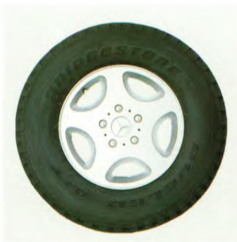
Het aangepaste 7,5 J x 16-wiel voor de vergrote remschijven
