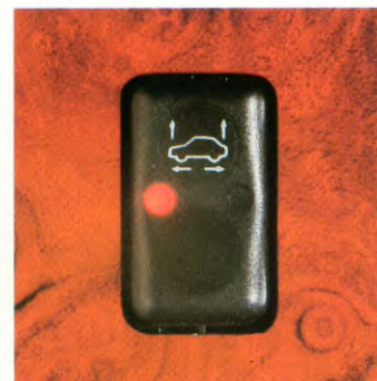
De wegsleepbeveiligingsschakelaar voorkomt het activeren van de alarminstallatie. Bij voorbeeld als de terreinwagen moet worden vervoerd (extra)
