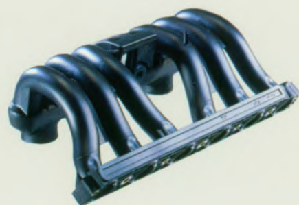
Het variabele inlaatspruitstuk zorgt bij de zescilinder motor voor een verbeterde cilindervulling.
