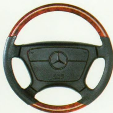
Ook in het als extra leverbare met hout en leder beklede stuurwiel is een full-size airbag gemonteerd, die in 0,03 seconde paraat is.
