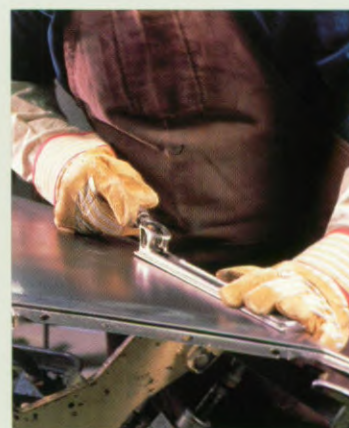
Bij het afwerken van de karrosserie worden terwille van de kwaliteit bepaalde werkzaamheden met de hand verricht.
