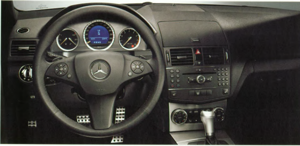
Achter het driespaaks lederen sportstuur zijn schakelpaddles aangebracht om bij de automatische transmissie met de hand te kunnen schakelen.
