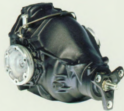
Meer veiligheid bij het wegrijden en op een aan één kant glad wegdek: het Automatische SperDifferentieel.
