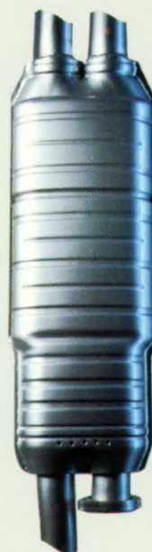
Ook in de 300 CE-24 Cabriolet standaard: de geregelde drieweg-katalysator.
