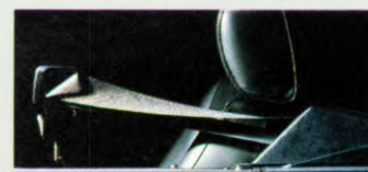
De elektrische gordelaanreikarmen brengen de gordels comfortabel binnen handbereik.
