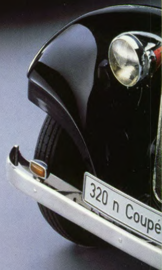
Mercedes 320 n Coupé, bouwjaar 1938; Zes-cilinder karburatiemotor; 57 kW (78 pk).
