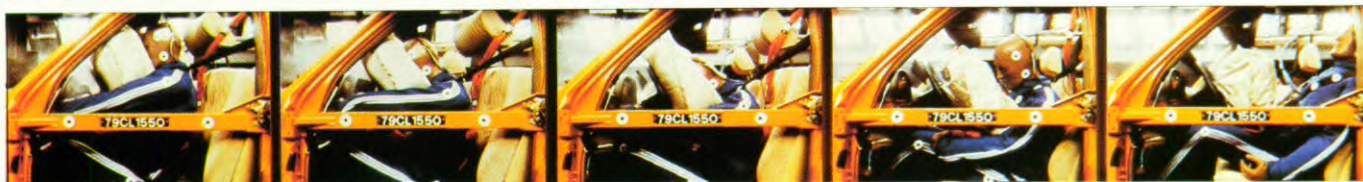
Elektronisch geregeld beveiligingssysteem met luchtzak en gordelspanner.
