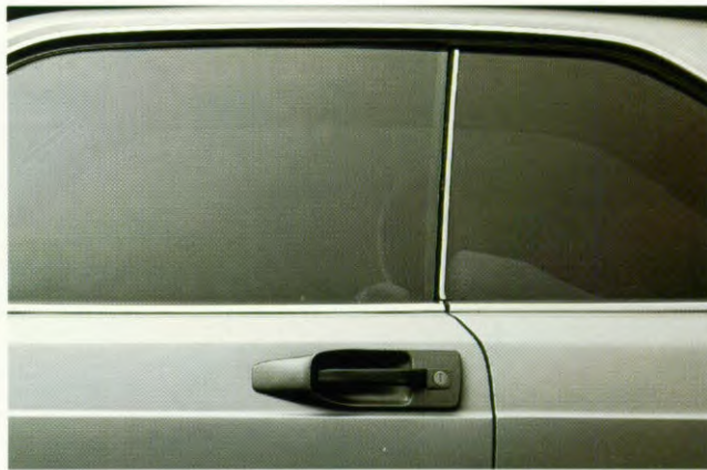
Portierhandgreep met afschermingsplaat en waterafvoer in de slotcilinder.
