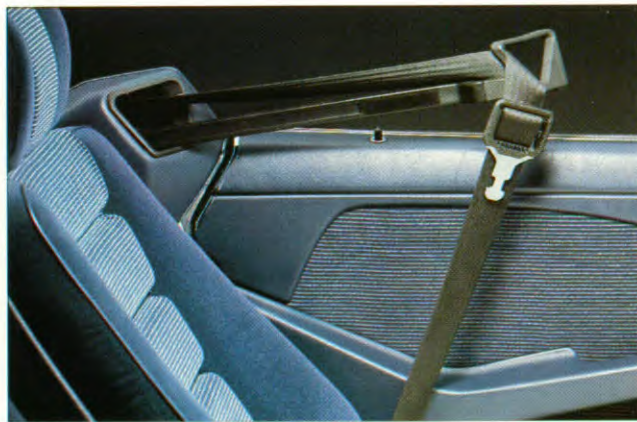
De rolgordels voor de bestuurder en de voorpassagier worden automatisch aangereikt.
