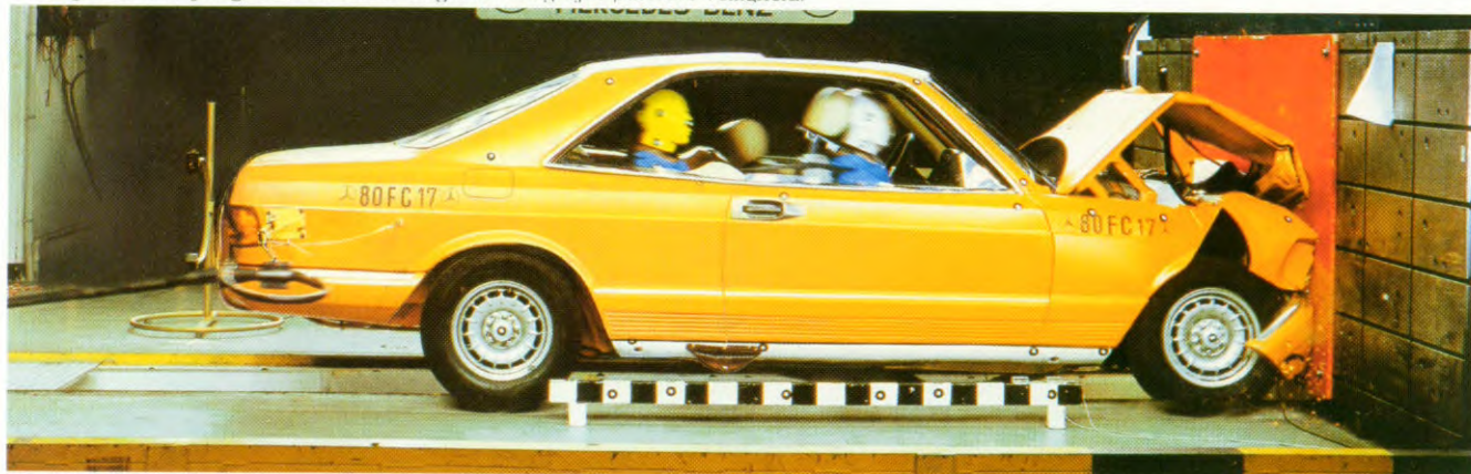
De verlengde kreukelzones met progressief oplopende weerstand tegen vervorming bieden bij frontale botsingen en aanrijdingen van achteren de grootst mogelijke passieve veiligheid.
