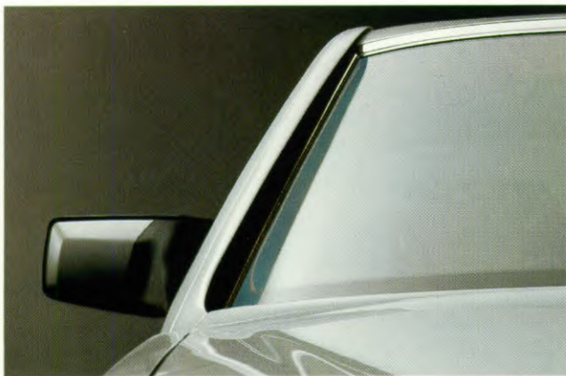
Voorstijl met verzonken regengoot- en aerodynamisch gevormde, van binnen uit verstelbare zijspiegel.
