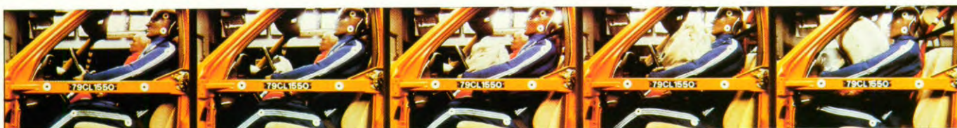
Elektronisch geregeld beveiligingssysteem met luchtzak en gordelspanner.
