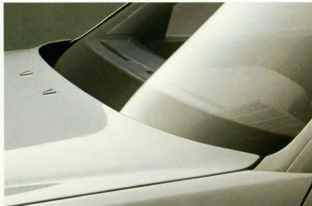
In ruststand verzonken ruitewissers met beveiliging tegen overbelasting.
