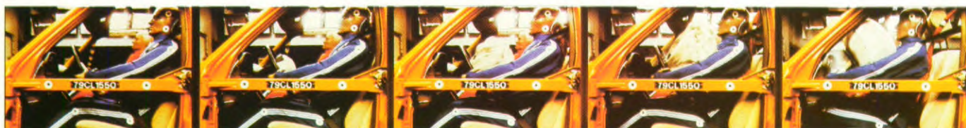
Elektronisch geregeld beveiligingssysteem met luchtzak en gordelspanner.
