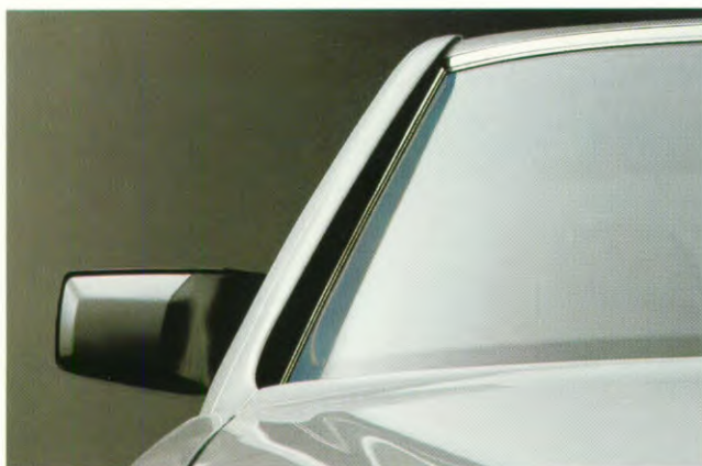
Vorststijl met verzonken regengoot- en aerodynamisch gevormde, van binnen uit verstelbare zijspiegel.
