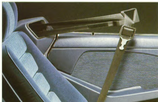
De rolgordels voor de bestuurder en de voorpassagier worden automatisch aangereikt.
