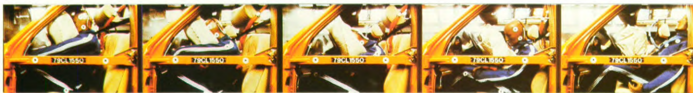
Elektronisch geregeld beveiligingssysteem met luchtzak en gordelspanner.
