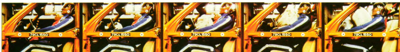
Elektronisch geregeld beveiligingssysteem met luchtzak en gordelspanner.
