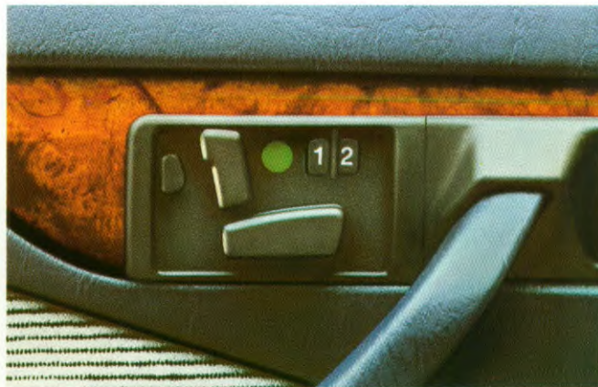
Met deze symboolschakelaars kunnen de voorzitplaatsen 8-voudig versteld worden. Ook de hoogte van de hoofdsteunen kan elektrisch versteld worden. Bovendien biedt de elektrische verstelling met geheugen de mogelijkheid om twee verschillende zittingen exakt vast te leggen (speciale uitvoeringen).
