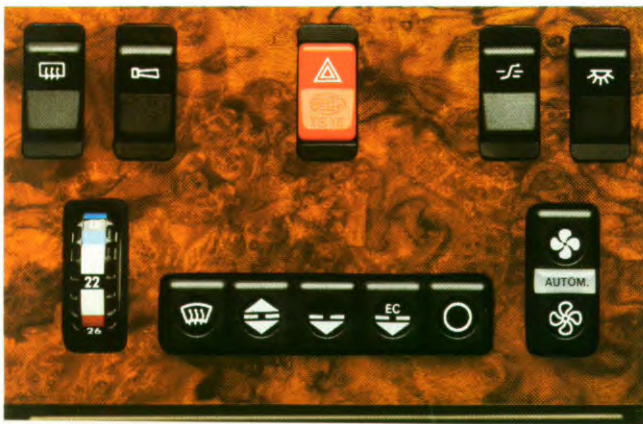
De elektronisch geregelde airconditioning houdt de eenmaal ingestelde temperatuur in het interieur konstant.
