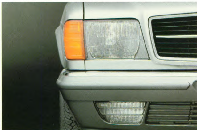
Geïntegreerde halogeen koplampunit met op de hoeken van de wagen geplaatste knipperlichten. Mistlampen in de bumpers.
