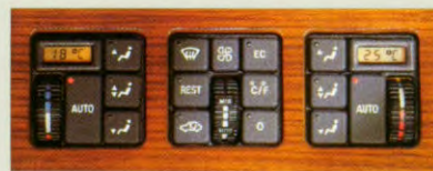
Twee "klimaatzones" in de auto: de airconditioning met automatische regeling.
