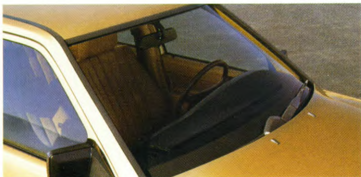
Aerodynamisch optimaal: de gelijkjnde voorruit.
