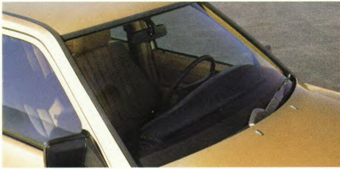
Aerodynamisch optimaal: de gelijmde voorruit.
