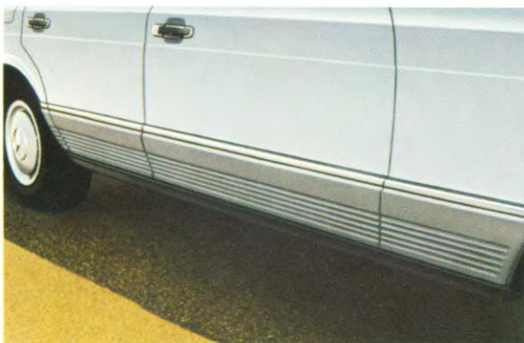
Bescherming opzij door zeer sterke kunststofplaat.
