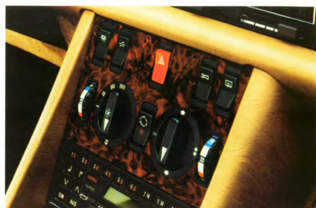
De airconditioning houdt de eenmaal ingestelde binnen-temperatuur konstant en is links en rechts apart regelbaar (tegen meerprijs).
