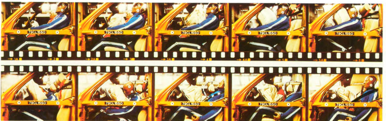
Elektronisch geregeld beveiligingssysteem met airbag (extra) en standaard gordelspanners.
