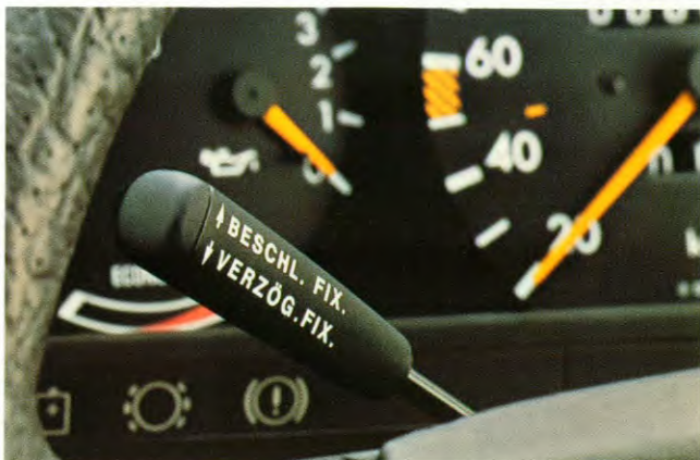
De tempomat houdt konstant elke tevoren ingestelde snelheid van meer dan 40 km/u aan. (Tegen meerprijs, in combinatie met automatische transmissie).
