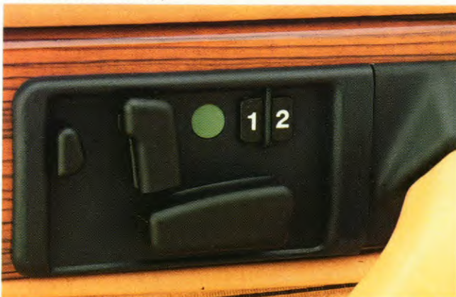
Met deze symboolschakelaars kunnen de voorzitplaatsen 8-voudig versteld worden. Ook de hoogte van de hoofdsteunen kan elektrisch versteld worden. Bovendien biedt de elektrische verstelling met geheugen de mogelijkheid om twee verschillende zitinstellingen exakt vast te leggen (speciale uitvoeringen).
