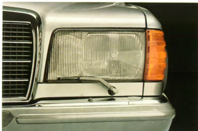
Geïntegreerde halogeen koplampunit met om de hoeken van de wagen geplaatste knipperlichten.
