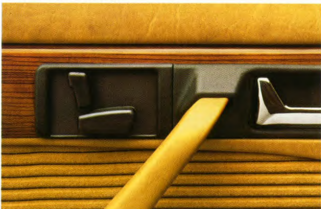
Met deze symbolischakelaar kunnen de voorstoelen achtvoudig elektrisch worden versteld (tegen meerprijs).
