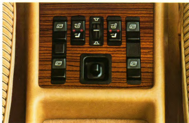
Elektrische zijruitbediening vóór en achter, elektrische voorstoelverwarming met 2 standen (tegen meerprijs).
