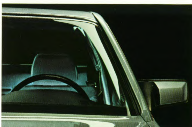
Voorruitstijl met verzonken regengoot en aerodynamisch gevormde van binnenuit verstelbare zijspiegels.
