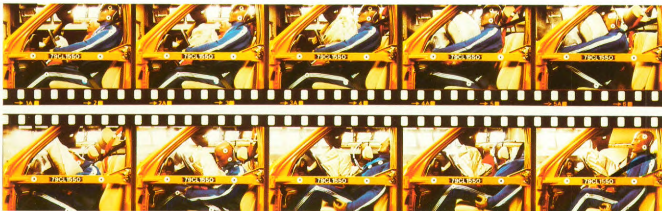
Elektronisch geregeld beveiligingssysteem met luchtzak en gordelspanner (tegen meerprijs).
