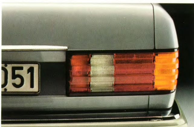
De karakteristieke vuilwerende dwarsribbels voorkomen het vuil worden van de achterlichten.
