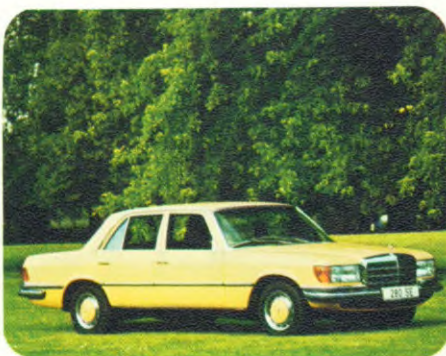
Niedrige Gürtellinie und die jederzeit überschaubare Front- und Heckpartie machen die Modelle 280 S und 280 SE übersichtlich. 87% der Rundumsicht sind Glasflächen.
