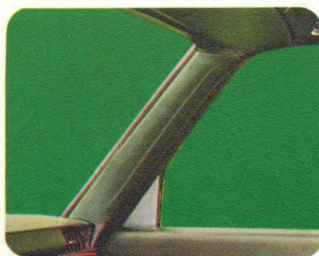
Hoher Überrollschutz durch eine gründlich getestete Dachkonstruktion, deren Festigkeit nach ESEM (Elasto-Statik-Element-Methode) berechnet wurde.
