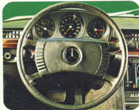
Großflächige, gepolsterte Aufprallplatte in der Mitte des Vierspeichen-Sicherheitslenkrads. Zentral im Blickfeld angeordnete, blendfreie Instrumente. Quarzgesteuerte Zeituhr.
