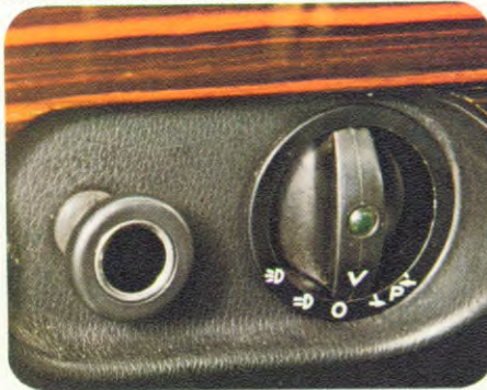
Alle Knöpfe, Schalter, Griffe sind deformierbar oder versenkt angeordnet. Ein zentraler Lichtschalter für Fahrlicht, Standlicht, Nebellampen, Nebelschlußleuchte, Parklicht.
