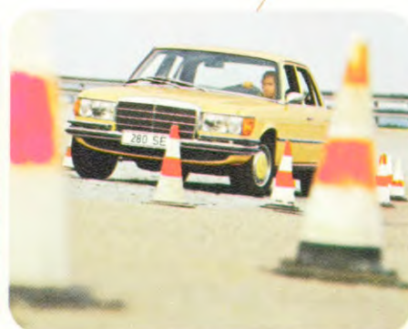
Beide Vorderräder legen sich beim Einschlagen der Lenkung schräg und stützen sich gegen die Straße ab. Das ermöglicht hohe Kurvengeschwindigkeiten.
