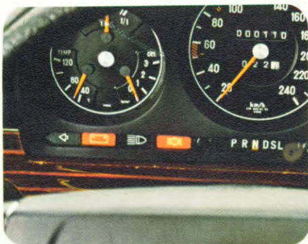
Zentral zusammengefaßte Kontroll-Leuchten mit Symbolen für Blinker, Fernlicht, Batterieladung und Funktion der Bremsen.
