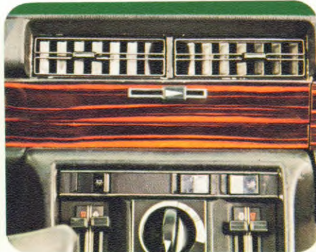
Insgesamt elf regulierbare Luft-Eintrittsöffnungen. In der Mitte der Armaturenanlage: großvolumige Frischluftzufuhr, stufenlos einstellbar nach allen Seiten.
