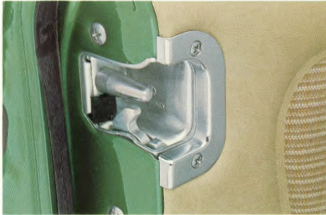
Het veiligheidspenslot weerstaat de zwaarste schokken.
