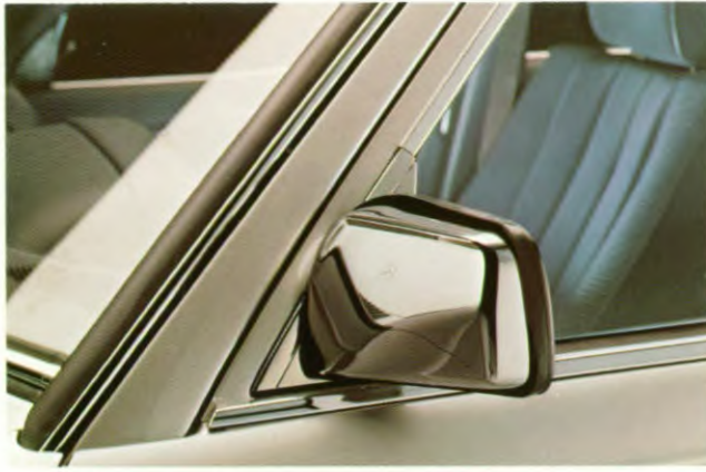
De aerodynamische buitenspiegel is verstelbaar vanuit het interieur.
