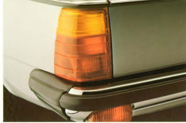
Royale achterlichten, die door hun geprofileerde oppervlak grotendeels schoon blijven.
