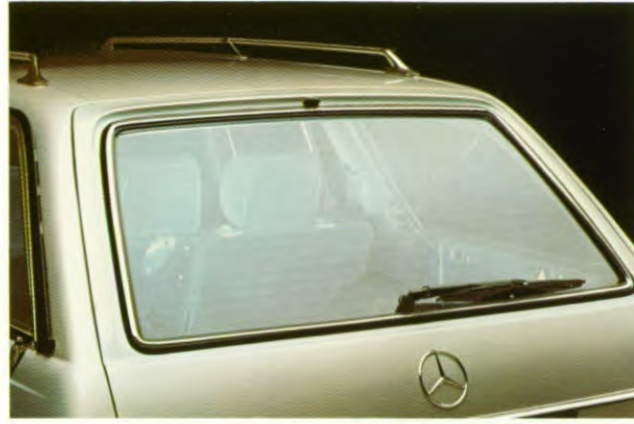
Ruitwisser en -sproeier op de achterraut, met wis/wasschakeling en intervalstand.
