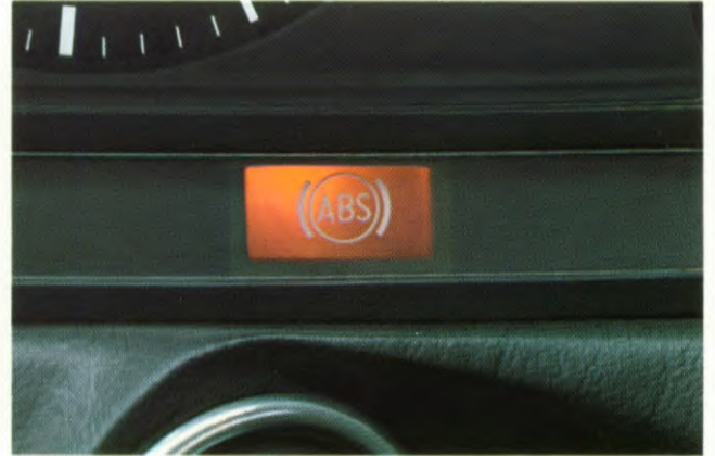
Het als extra leverbare Anti-Blokkeer-Systeem (ABS) garandeert ook op natte, besneeuwde of beijzde wegen optimale remwerking en besturing.
