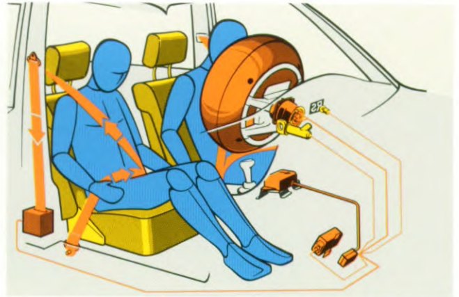
De werking van het als extra leverbare elektronische veiligheidssysteem, bestaande uit luchtzak en gordelspanner.
