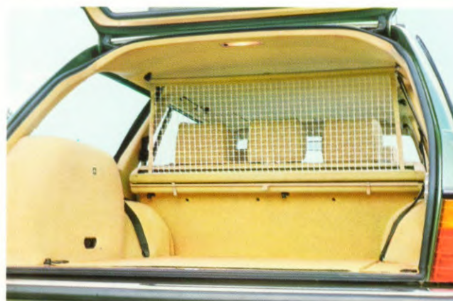
Het veiligheidsnet vormt een scheiding tussen passagiers- en laadruimte.
