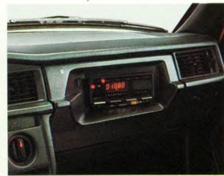
Dashboardkastje voorbereid op de inbouw van elektronische taximeters (190 D - 190 E 2.3).
