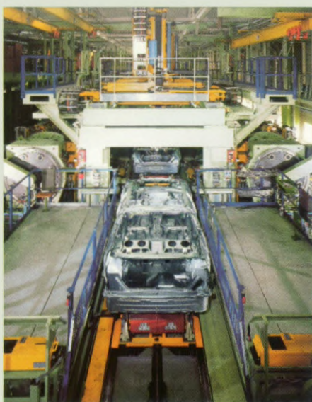
Een flexibele produktielijn voor de montage van de personenwagenkarrosserieën in onze fabriek te Sindelfingen.
