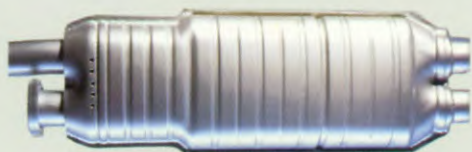
Bij Mercedes-Benz al jaren standaard: de geregelde drieweg-katalysator.
