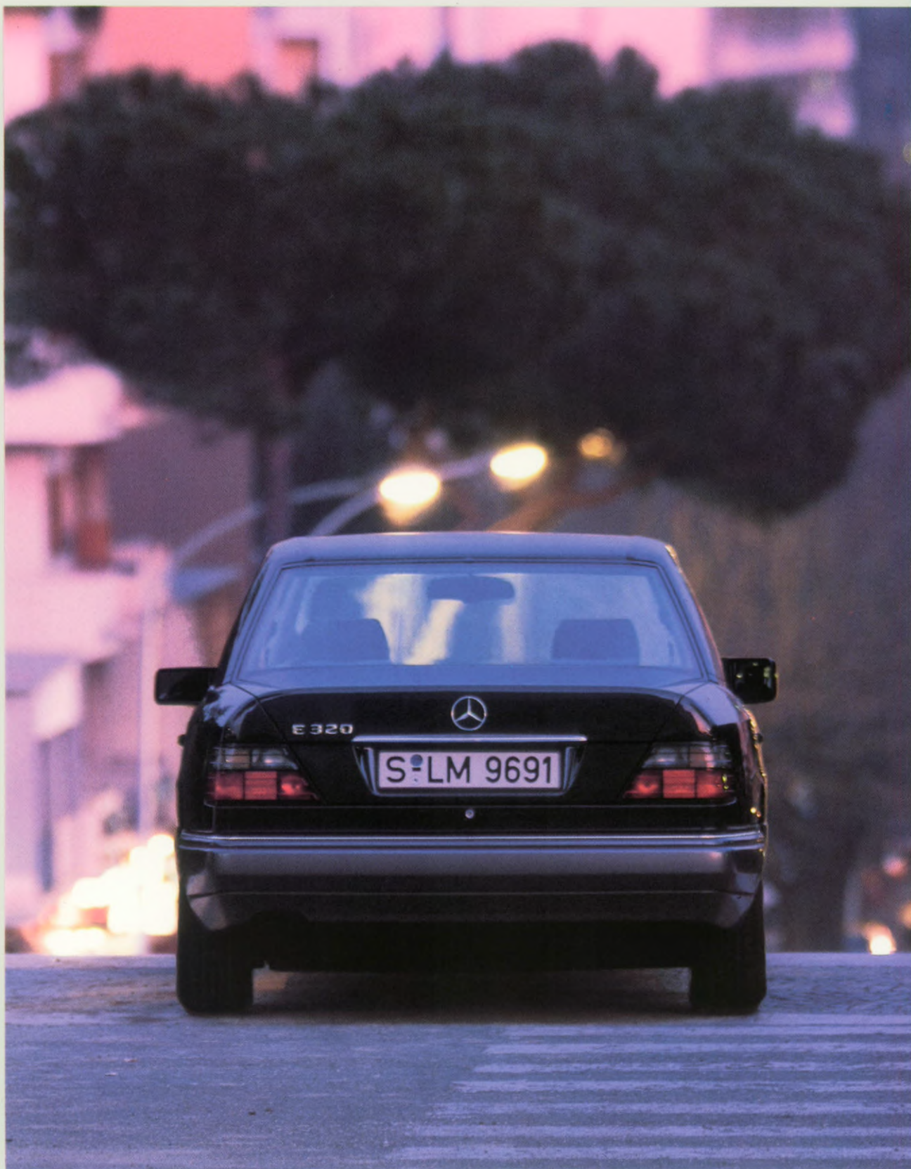
De achterkant van de E-klasse: de bumper en het kofferdeksel zijn gewijzigd; er zijn bichromatische achterlichten gemonteerd.
