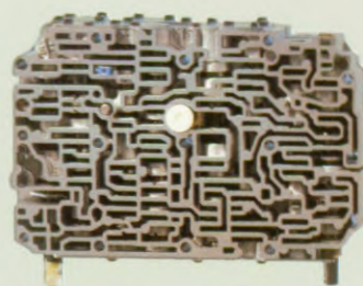
Het "brein" van een automatische versnellingsbak: het hydraulische regelhuis.
