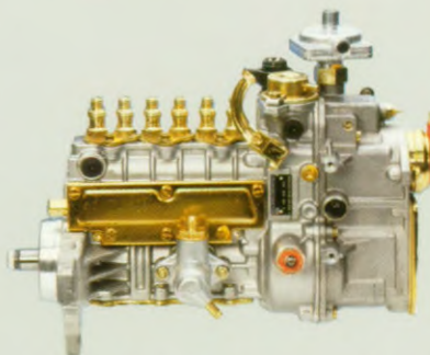
Hier wordt de optimale hoeveelheid brandstof naar de inspuitspruitstukken gevoerd.
