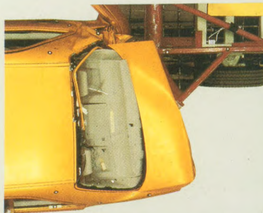
De karrosserie van de C-klasse is gekonstrueerd voor het opvangen van de botskrachten bij asymmetrische botsingen. Niet alleen bij frontale botsingen, maar ook bij aanrijdingen achterop.
