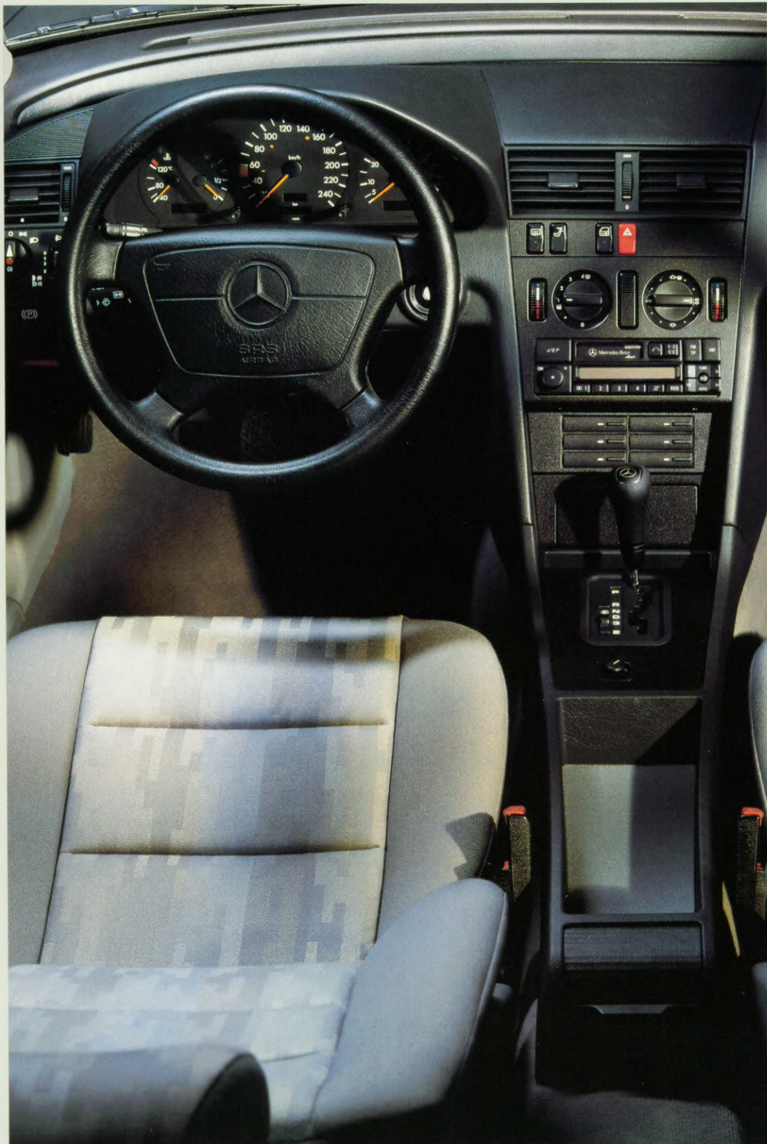
Twee "klimaatzones" in de auto: bij het elektronisch geregelde verwarmings- en ventilatiesysteem kunnen de bestuurder en de voorpassagier de gewenste temperatuur afzonderlijk instellen. Eén van de comfortabele details.
