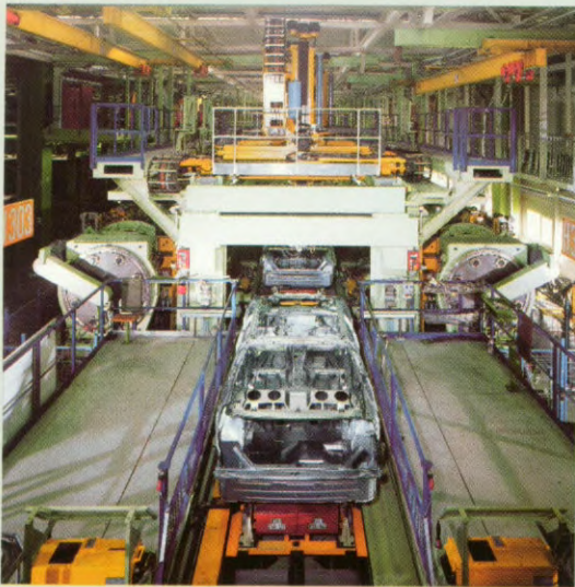
De flexibele produktielijn, voor de montage van de karrosserieën in Sindelfingen.
