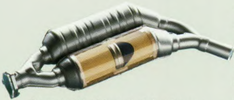
De geregelde drieweg-katalysator van de nieuwste generatie kan later grotendeels door ons worden gerecycled.
