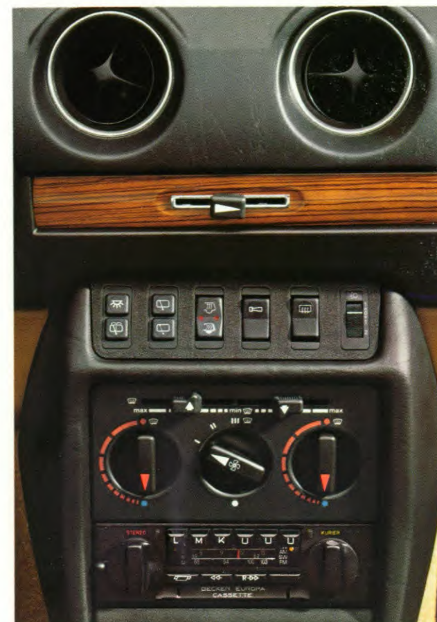
Stof- en tochtvrije permanente ventilatie met 3-traps ventilator voor verwarmde of koele lucht naar voorruit, zijruiten en voetenruimten voor- en achterin.
