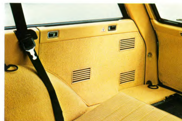
Bij extreem lage buitentemperaturen kan de voetenruimte van de op de wegklapbare derde bank meerdende passagiers door middel van een extra verwarming verwarmd worden.
