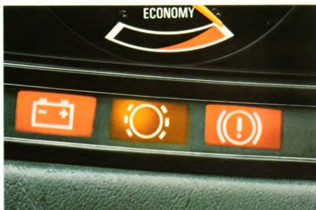
De indikator voor de slijtage van de remvoering geeft tijdig aan wanneer deze moet worden vervangen.
