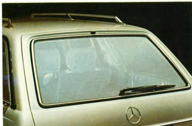
Ruitewisser en -sproeier op de achterraut, met wis/wasschakeling en intervalstand.
