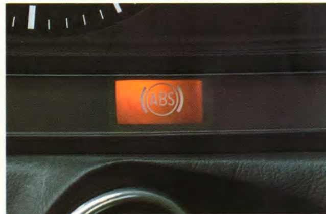
Het als extra leverbare Anti-Blokkeer-Systeem (ABS) garandeert ook op natte, besneeuwde of beijzelde wegen optimale remwerking en besturing.
