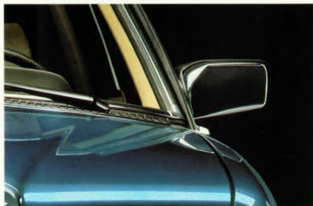
De aerodynamische achteruitkijkspiegel is verstelbaar vanuit het interieur.
