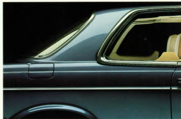
Onzichtbaar weggewerkte sleuven zorgen voor tochtvrije ventilatie
