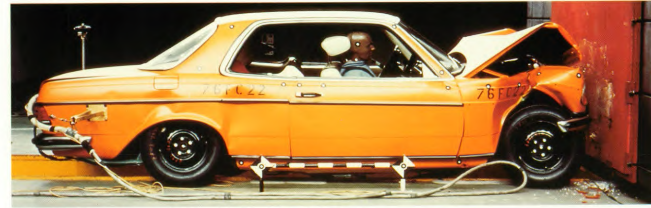
De kreukelzones met progressief oplopende weerstand tegen vervorming bieden bij frontale botsingen en aanrijdingen van achteren de grootst mogelijk passieve veiligheid.
