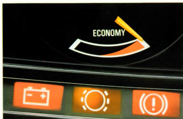
De indikator voor de slijtage van de remvoering geeft tijdig aan wanneer deze moet worden vervangen.
