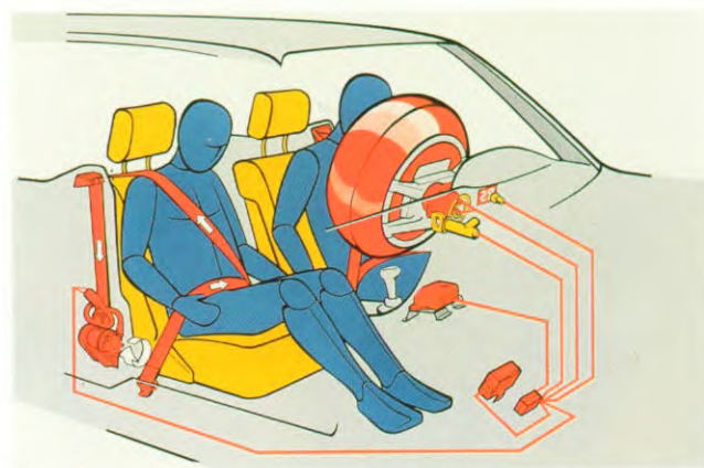
De werking van het als extra leverbare, elektronisch gestuurde veiligheidssysteem met luchtzak en gordelspanner.
