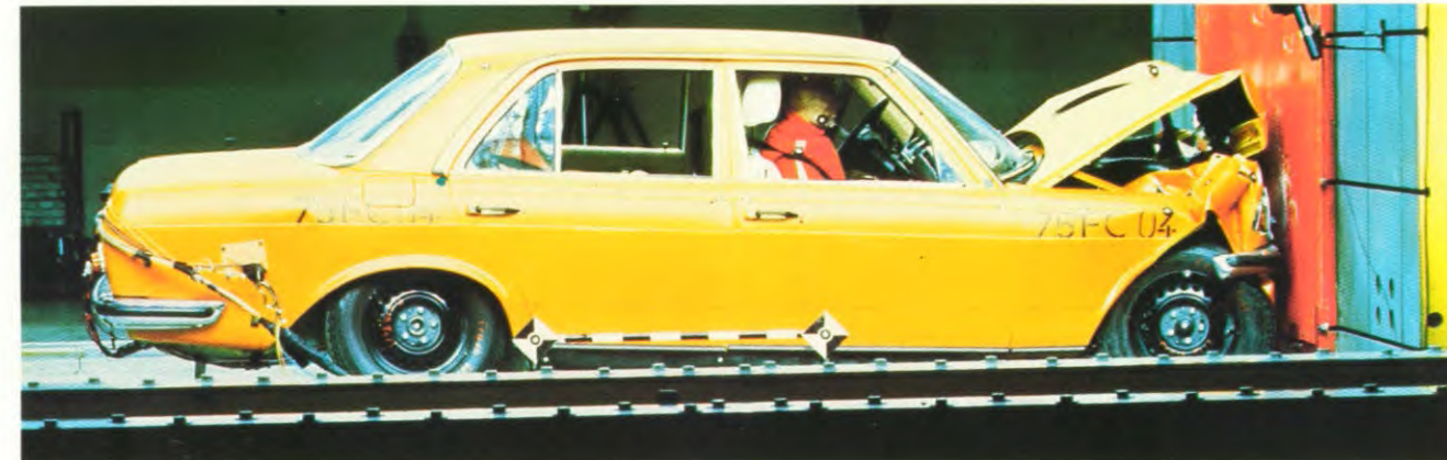
De kreukelzones met progressief oplopende weerstand tegen vervorming bieden bij frontale botsingen en aanrijdingen van achteren de grootste mogelijke passieve veiligheid.
