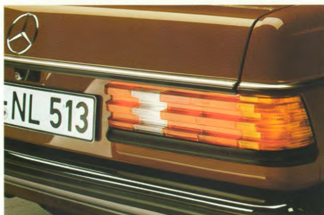
De karakteristieke vormgeving vermindert vervuiling van de achterlichten.
