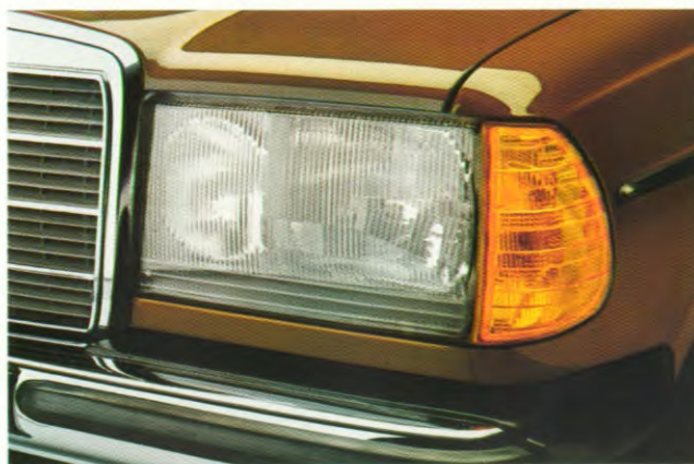
Halogeen koplampunit met geïntegreerde mistlampen en ook van de zijkant zichtbare knipperlichten.
