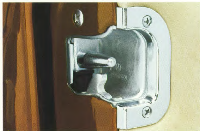
Het veiligheidsspenslot is zo gekonstrueerd, dat het bij een ongeval niet vanzelf opengaat.
