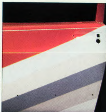
De carrosserie wordt met corrosiewerende epoxygrondverf bespoten.
