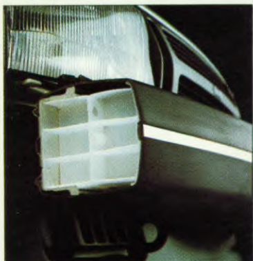
In de zelfherstellende bumpers zijn plastic blokken met cellenstructuur verwerkt.
