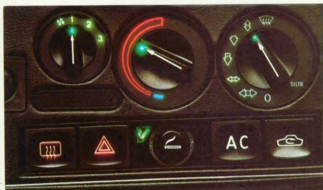
Geprogrammeerd en vacuüm-geregeld verwarmings- en ventilatiesysteem.
