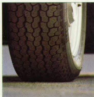
Banden met een lage rolweerstand besparen brandstof.
