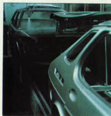
Een laag hechtingslak en de steenslag-lak worden opgespoten voor de bovenste, dekkende laklaag wordt aangebracht.
